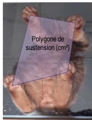
**Figure 18. Dispositif de mesure du polygone de sustentation chez le chat.** Photographie de dessous d'un animal en position érigée sur ses quatre pattes au repos sur un plateau transparent gradué. L'évaluation de la surface du polygone de sustentation est effectuée par ordinateur à partir des points correspondant aux coussinets plantaires.
