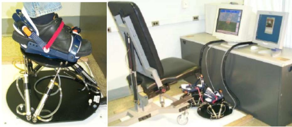
**Figure 1.14:** Interface haptique de la cheville de Rutgers (à gauche) et une plate-forme mis en place (à droite) [Boian et al., 2003b].
