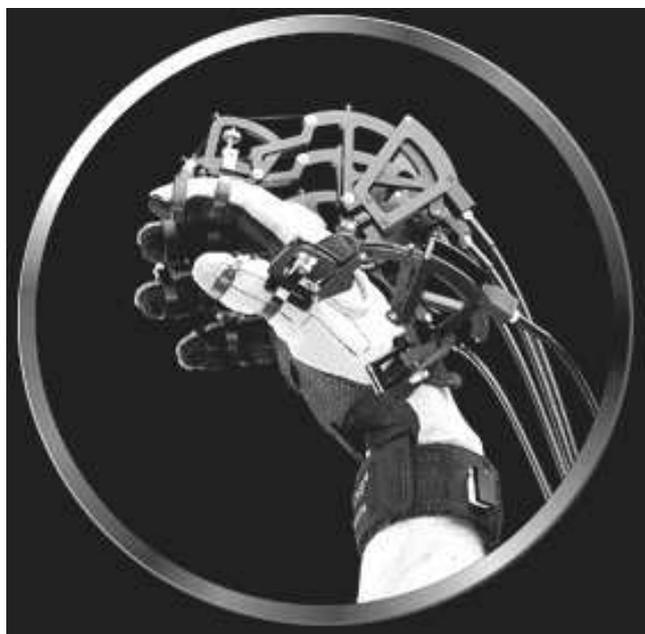
*Figure 8.35 : Le gant de données à cinq retours d'effort CyberGrasp de Virtual Technologies, copyright Immersion S.A.*
