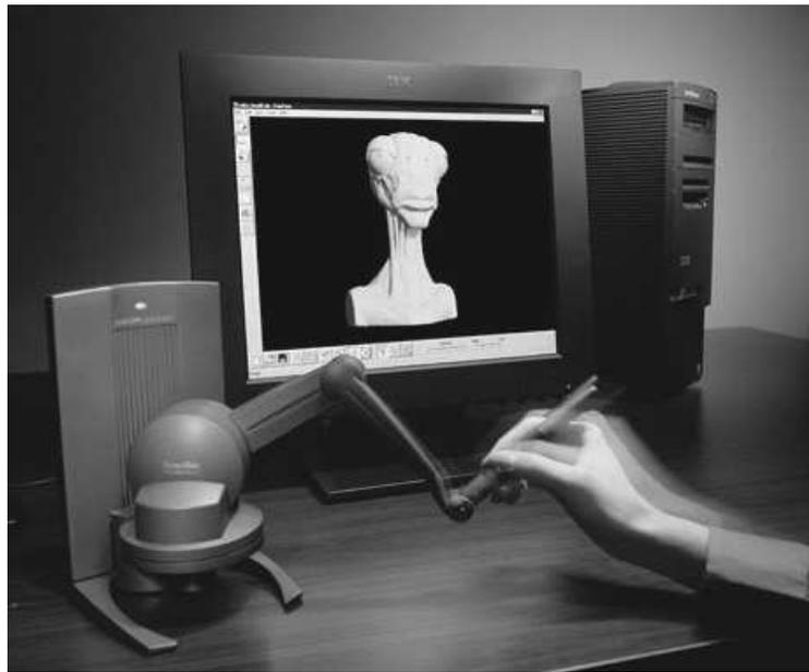
Figure 8.17 : Le Phantom Desktop de SensAble, copyright photo SimTeam
