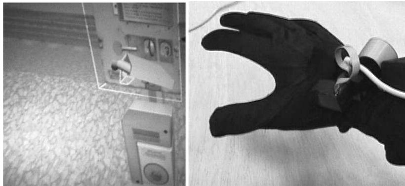
Figure 2.17 : Interface comportementale : gant de données pour manipuler le téléphone, l'aiguillage, etc., photo SNCF
