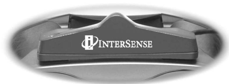
*Figure 5.16 : L'InterTrax2 à 3 degrés de liberté d'orientation d'InterSense, fixé sur un visiocasque, copyright photo SimTeam*
