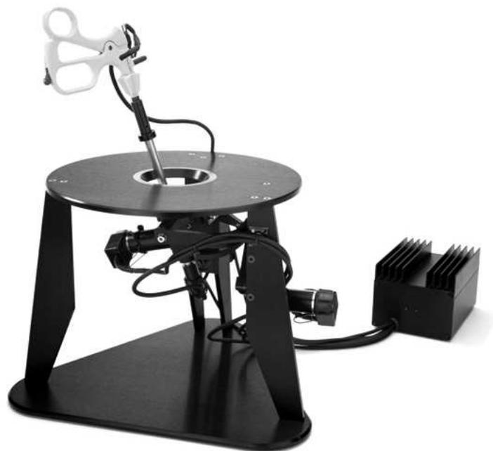
*Figure 8.26 : L'interface à retour d'effort Impulse Engine de Immersion Corporation, copyright photo Immersion Corporation*
