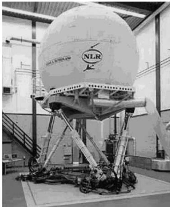
*Figure 11.8 : Simulateur d'avion*
