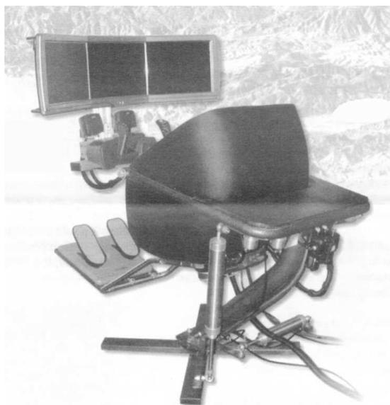
*Figure 11.5 : Le micro simulator de Panoram technologies avec 3 écrans, copyright photo Panoram Technologies*
