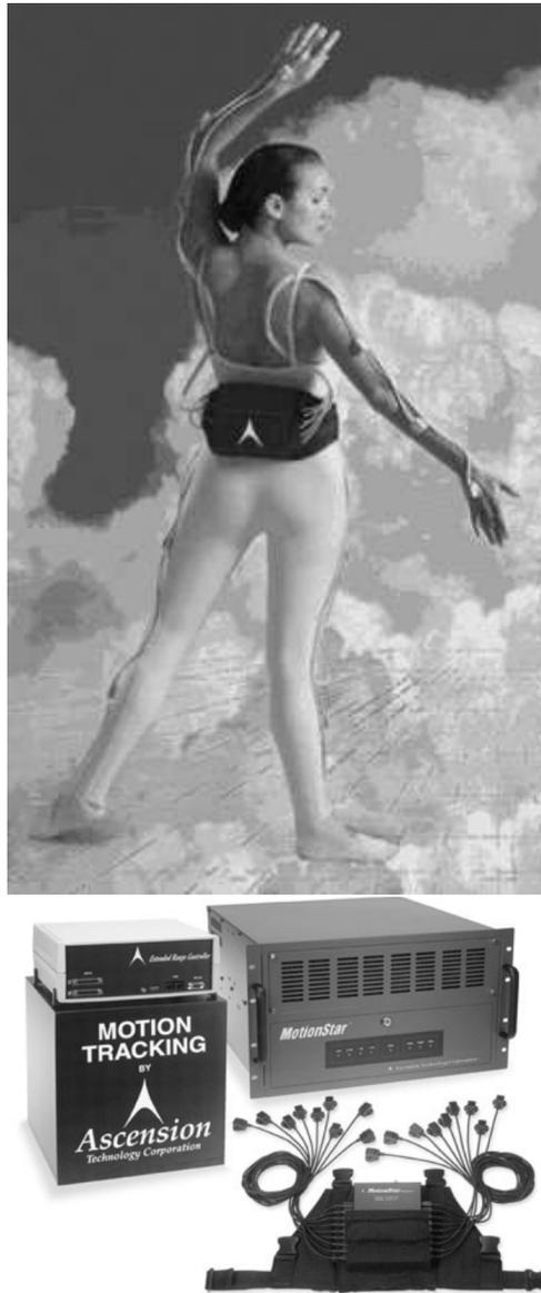
Figure 6.1 : La combinaison de données MotionStar sans fil d'Ascension, copyright photo Immersion S.A.
