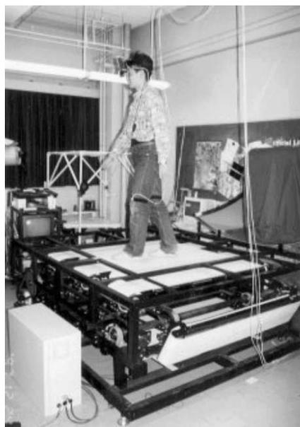
Figure 6.17 : Interface de locomotion par tapis 2D Treadmill, copyright photo Professor Iwata
