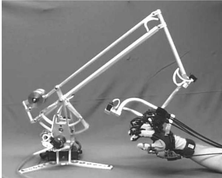
Figure 8.37 : L'interface à retour d'effort CyberForce de Virtual Technologies, copyright photo Immersion S.A.
