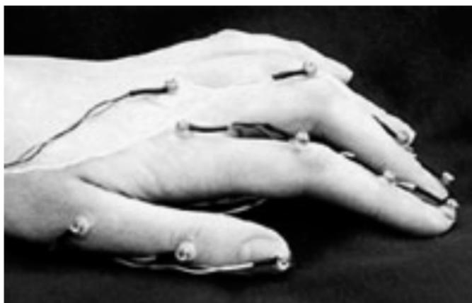
*Figure 6.7 : La détection des mouvements d'une main par le système de Coda motion capture, copyright photo Charnwood Dynamics*
