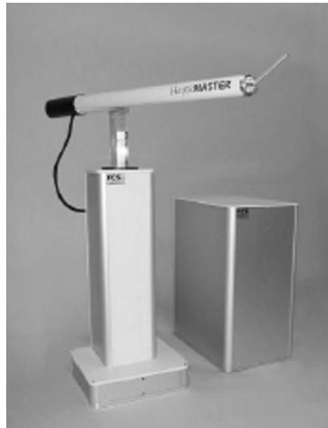
Figure 8.22 : L'interface à retour d'effort HapticMaster de FCS Control Systems
