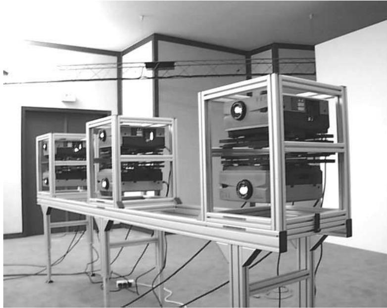
Figure 2.11 : Réalisation de l'écran avec six vidéoprojecteurs LCD (3860x2048 pixels au total), photo de l'École des mines de Paris
