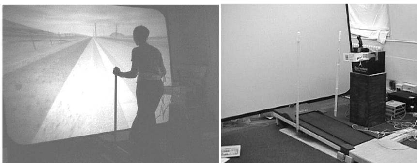
Figure 2.15 : Interfaçage comportemental du déplacement 2D par un tapis roulant asservi et un "guidon" pour tourner, photo de l'École des mines de Paris
