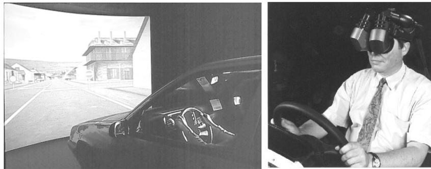
Figure 1.1 : Simulation de la conduite d'une voiture avec visiocasque ou sur écran de simulateur (Copyright Photo PSA Peugeot Citroën)
