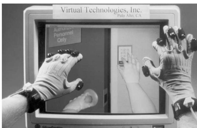
Figure 9.5 : Le gant de données Cyberglove avec retour vibro-tactile Cybertouch de Virtual Technologies, copyright photo Immersion S.A.
