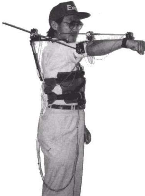
*Figure 6.9 : L'interface de localisation des membres supérieurs de Exos, copyright photo Exos*
