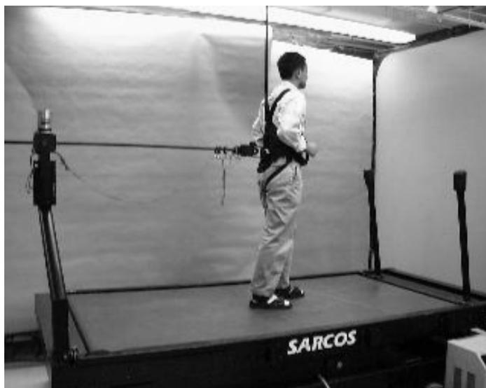
Figure 13.6 : Tapis unidirectionnel
