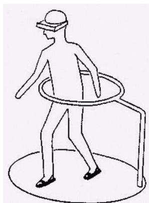
Figure 6.13 : Interface de locomotion à patins à roulettes
