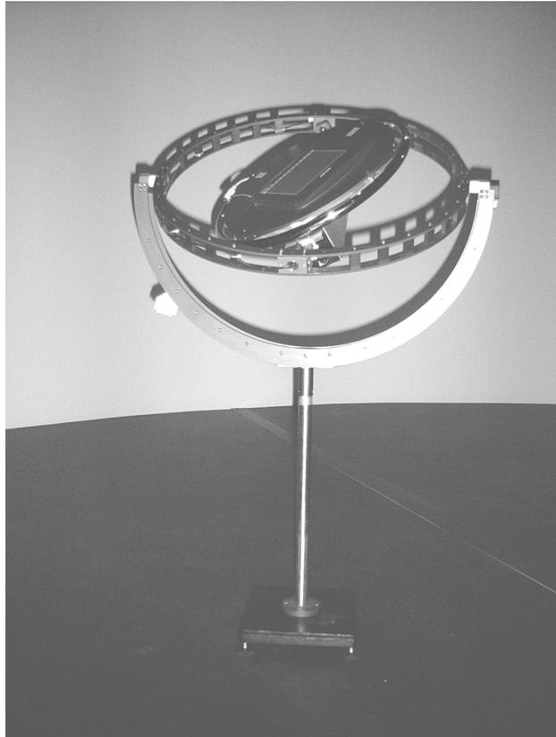
*Figure 7.13 : Le CAT, interface de commande à 6ddl pour grand écran, photo LABRI*
