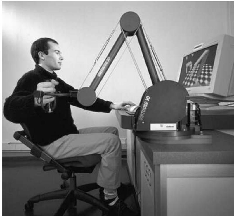
*Figure 8.20 : Le Virtuose 3D du CEA-LIST et de Haption, copyright photo Haption*
